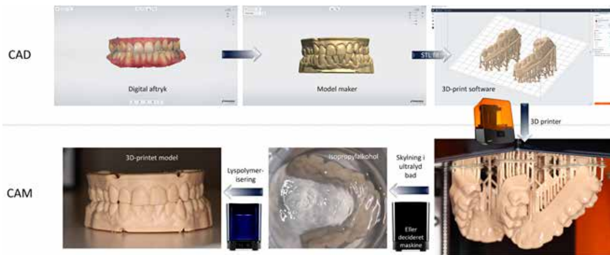
Fig. 2. Den digitale arbejdsgang for at fremstille en 3D-printet model.
