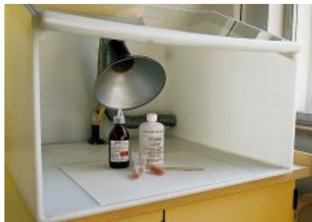
Fig. 5. Reparation af knækket protese. Væsken indeholder methylmethacrylat. Det er gruppens anbefaling at gravide ikke arbejder med methylmethacrylatholdige materialer.
