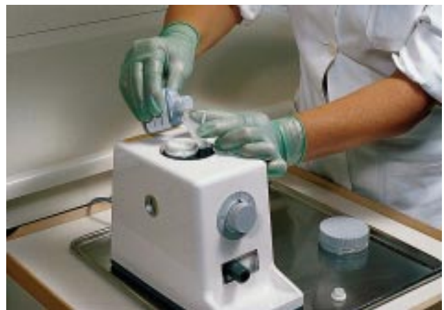
Fig. 2. Dentomat til fremstilling af amalgam. Maskinen anbringes på en bakke for at undgå kviksølvspild. Spild kan være en vigtig kilde til forurening af rumluften. Gravide kan arbejde med amalgam, deltage ved udboring af amalgamfyldninger osv., men det forudsætter foranstaltninger mod udsættelse for kviksølv.
