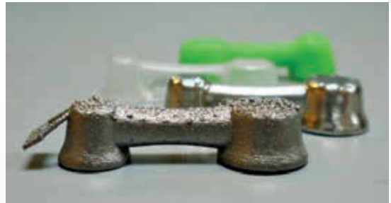
Fig. 1. Fyra stilistiska broskelett som representerar fyra olika framställningstekniker för ett och samma material: Lasersintrat CoCr, fräst CoCr, förlaga för gjutning av CoCr framställd genom fräsning i urbrännbart material, vaxförlaga för för gjutning av CoCr enligt lost-wax metoden. De tre första är framställda med CAD/CAM teknologi.
