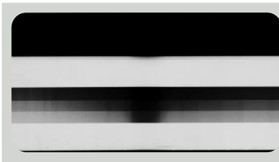
Fig. 9. Panoramafilm eksponeret med testfantom DIN Norm-6868. Der ses tre horisontalt forløbende bånd med forskellige sværtningsgrader. Midt på filmen har båndene en kraftigere sværtning som følge af at apparatets hastighed er nedsat når der eksponeres lige bagfra (gennem columna cervicalis).
