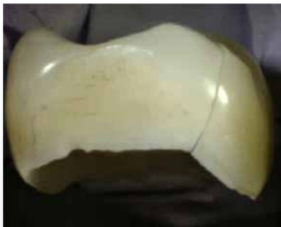
Fig. 6. Eksempel på en 2-lags zirkoniakrone, fraktureret under klinisk brug efter mindre end tre år. Det ses tydeligt, at der er flere mindre afskalningsdefekter i kronekanten. En af disse er udgangspunkt for den totale fraktur, som har delt kronen i to.
