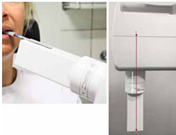
Fig. 2. En lang tubus er nemmere at placere korrekt i forhold til holderens sigtepinde. Det er et lovkrav, at afstanden fra røntgenrørets fokus (markeret med en lille prik) til enden af tubus skal være mindst 20 cm (rød pil).
