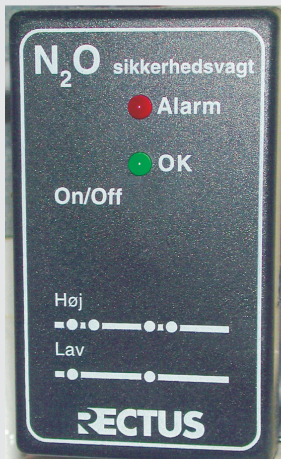
Fig. 6. Alarmanlæg som tilsluttes udsugningsenheden.
