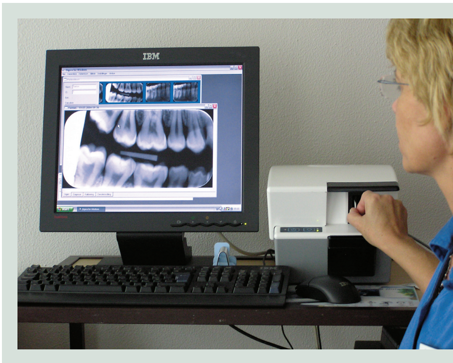
Fig. 2. Digora Optime skanner aflæser, renser og »spytter« pladen ud på 5-8 sek. og er dermed den hurtigste skanner.
