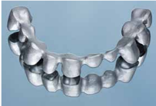
Fig. 1. Eksempel på et broskelet fremstillet ved selektiv lasersmeltning (SLM) af kobolt-kromlegering. (Foto: Harald Gjengedal).
